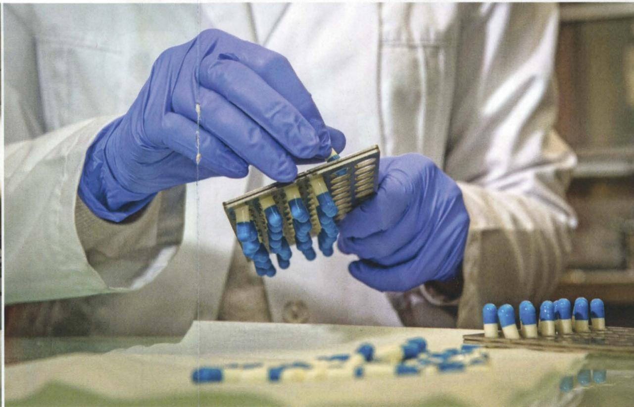
**RANGEMENT** Il place les capsules contenant la substance active contre la sclérose en plaques dans une grille. Celle-ci sera ensuite plongée dans une solution qui solidifie les capsules afin que celles-ci résistent au suc gastrique.
