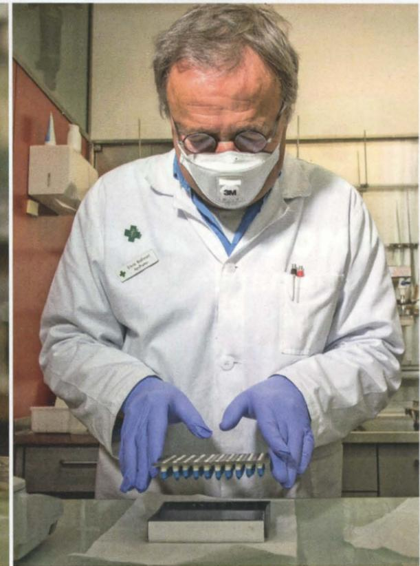
**TREMPAGE** Il met les gélules dans le liquide quelques secondes puis les fait sécher vingt minutes.
